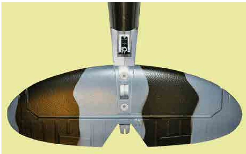
I uttaget framför stabilisatorn ser man servot för sporrhjulet.
