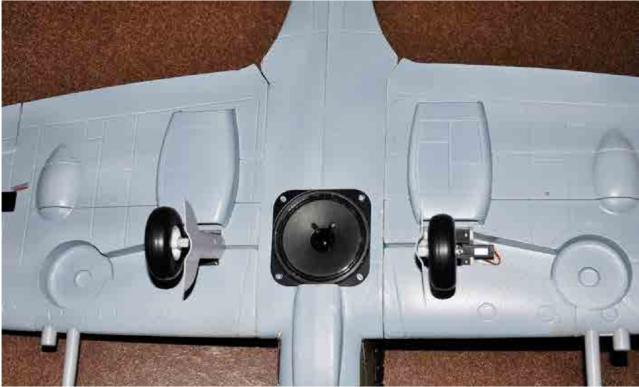
En 10 cm högtalare passar bra, skall förses med skyddsnet.
